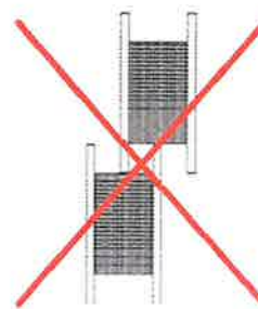
Rys. Błędne składowanie bębnow na placu (widok od góry)
