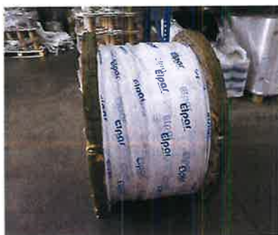
Zdj. Kabel zabezpieczony folią odporną na promienie UV
